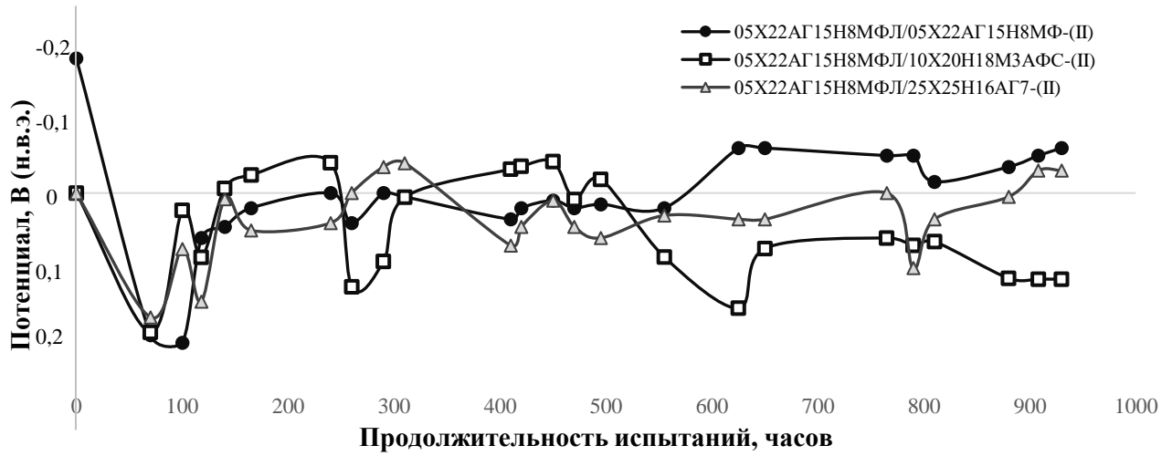
Рис. 3.52 – Измерение потенциалов коррозии образцов СС.
